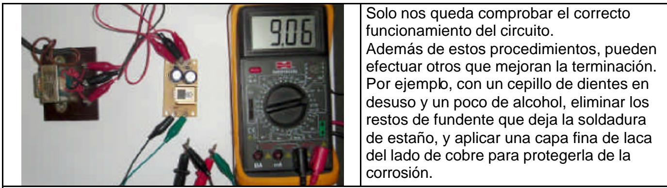
Solo nos queda comprobar el correcto funcionamiento del circuito. Además de estos procedimientos, pueden efectuar otros que mejoran la terminación. Por ejemplo, con un cepillo de dientes en desuso y un poco de alcohol, eliminar los restos de fundente que deja la soldadura de estaño, y aplicar una capa fina de laca del lado de cobre para protegerla de la corrosión.
