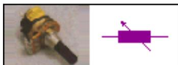
**Potenciómetros** Son resistencias variables, en su interior tienen una pista de carbón y un cursor que la recorre. Según la posición del cursor el valor de la resistencia de este componente cambiará.
