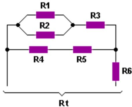
Podemos comenzar por los circuitos mas sencillos como resolver  $R_{1-2}$ , que representa la resistencia total entre  $R_1$  y  $R_2$ , como están en paralelo...
