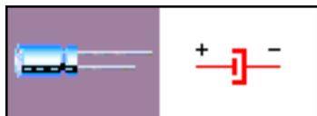
**Condensador ó Capacitor electrolítico** Estos almacenan más energía que los anteriores, eso sí, se debe respetar la polaridad de sus terminales. El más corto es el negativo. o bien, podrás identificarlo por el signo en el cuerpo de componente.
