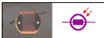
**Fotocelda** También llamada LDR. Una fotocelda es un resistor sensible a la luz que incide en ella. A mayor luz menor resistencia, a menor luz mayor resistencia.
