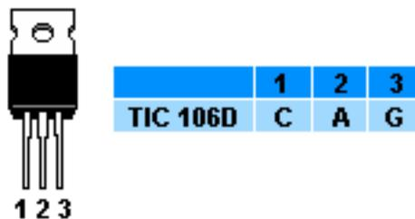
El SCR es una llave electrónica, que se activa cuando se aplica un pequeño voltaje positivo a su compuerta **G** (gatillo). No creas tan fielmente en todo lo que yo digo, monta el circuito y pruébalo.
