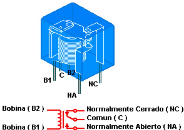
**B1** y **B2** son los terminales de alimentación de la bobina, cuando circule corriente por ellos el relé se activará cambiando de posición su interruptor interno y el terminal **C** se conectará con el terminal **NA**.
