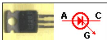
**SCR o TIC 106** Son llaves electrónicas, y se activan mediante un pulso positivo en el terminal G. muy común en sistemas de alarma. Sus terminales son **Á**nodo, **C**átodo y **G**atillo.
