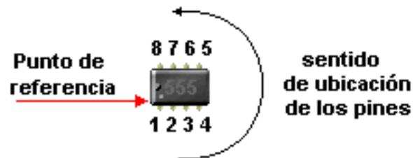
Como verás el integrado en cuestión es un 555, o bien NE555. Se trata de un temporizador (TIMER), comuntamente utilizado como un generador de pulsos, y la frecuencia de éstos puede variar de 1 pulso por segundo hasta 1 millón de pulsos por segundo, sorprendente verdad?.
