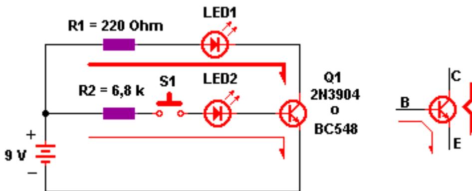
Cuando acciones **S1** llegará una cierta cantidad de **corriente** a la base del transistor, esta controlará la cantidad de **corriente** que pasa del Colector al Emisor, lo cual puedes notar en el brillo de los LED's.
