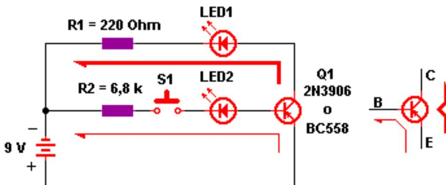
Nuevamente la corriente de base controla la corriente de colector para producir el efecto de AMPLIFICACIÓN.
