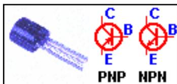
**Transistores** Cómo lo digo...! Básicamente un transistor puede controlar una corriente muy grande a partir de una muy pequeña. muy común en los amplificadores de audio. En general son del tipo NPN y PNP, que es eso?, no desesperes que pronto se aclararán tus dudas, sus terminales son; **C**olector, **B**ase y **E**misor.
