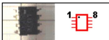
**Circuitos Integrados (IC)** Un Circuito Integrado (IC) contiene en su interior una gran variedad de componentes en miniatura. Según el IC. de que se trate tendrá distintas funciones o aplicaciones, pueden ser amplificadores, contadores, multiplexores, codificadores, flip-flop, etc. Sus terminales se cuentan en sentido opuesto al giro de las agujas del reloj tomando un punto de referencia.
