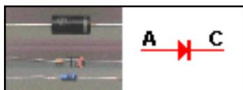
**Diodo** Al igual que los LED's sus terminales son **ánodo** y **cátodo** (este último, identificado con una banda en uno de sus lados), a diferencia de los LED's éstos no emiten luz.
