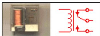
**Relé** Básicamente es un dispositivo de potencia, dispone de un electro-imán que actúa como intermediario para activar un interruptor, siendo este último totalmente independiente del electro-imán.
