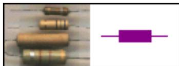
**Resistencias o Resistores** Presentan una cierta resistencia al paso de la corriente, sus valores están dados en Ohmios, según un **Código de colores** .
