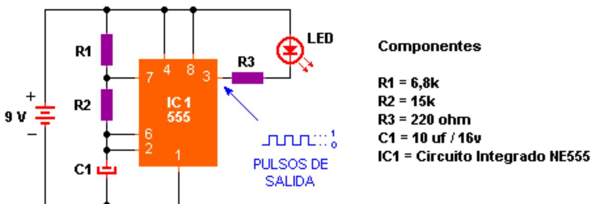
Observa la polaridad de la fuente respecto al LED..., te habrás dado cuenta que la única forma de encenderlo es que el **pin 3** de **IC1** sea negativo. Y lo será..., observa la onda rectangular de los **pulsos de salida**..., cuando esté arriba será (+) o 1, y el LED estará apagado. Cuando esté abajo será (-) o 0, entonces el LED se encenderá. Según la señal de salida el LED encenderá
